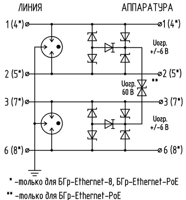
Рисунок 3.2 Электрическая схема
