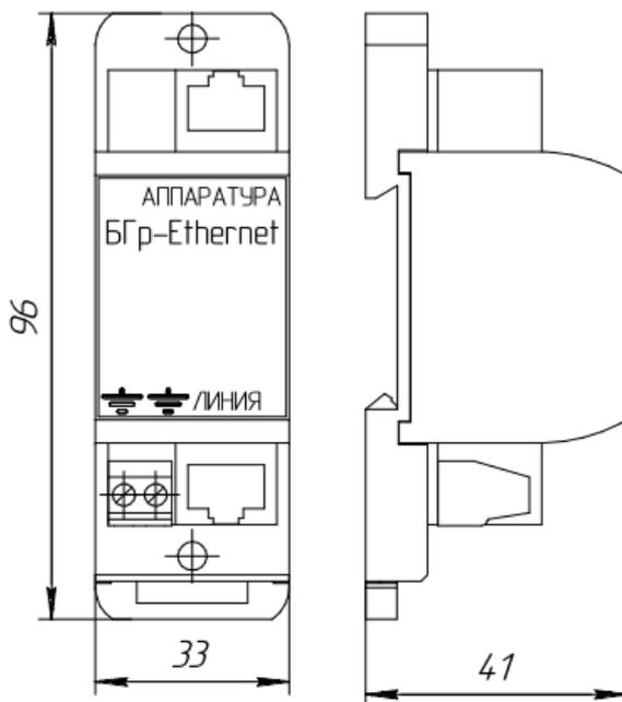
Рисунок 3.1 - УЗИП БГр-Ethernet
